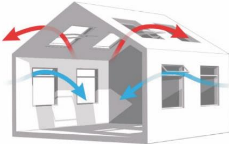
Figure 6: Dispositif d'aération des bâtiments
